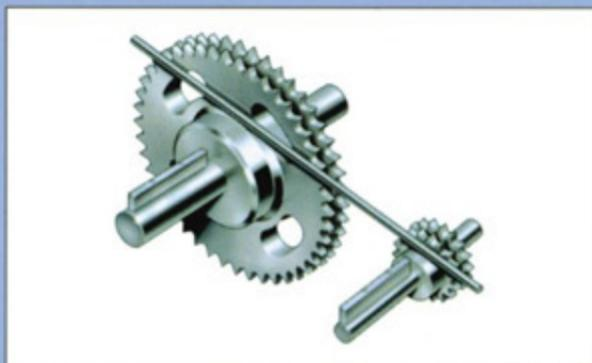
在几个不同的位置用直尺靠近链轮的加工面。以检查链轮的平行度，也可检查链轮是否存在晃动。尼龙或类似材料的线是用来代替直尺的好工具，它尤其适用于较长的中心距离。
