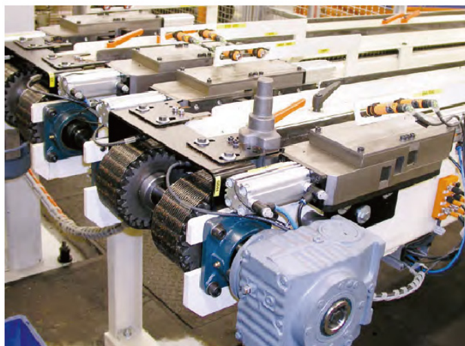
铸铁或锻造件的重型多车道存储系统。
