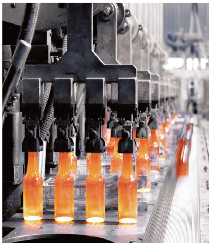
空心玻璃制造商的IS机器输送热瓶 然后进入陶瓷工艺流程。
