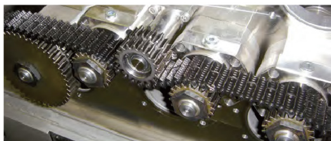
Biflex齿形链，滚子驱动用于真空应用中的 带有特殊涂层的齿形链
