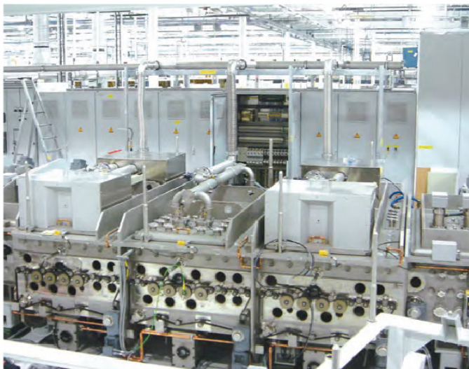
制造太阳能电池的真空镀膜设备上齿形链
